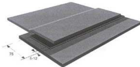
Rys. 18: Klejenie folii EPDM
